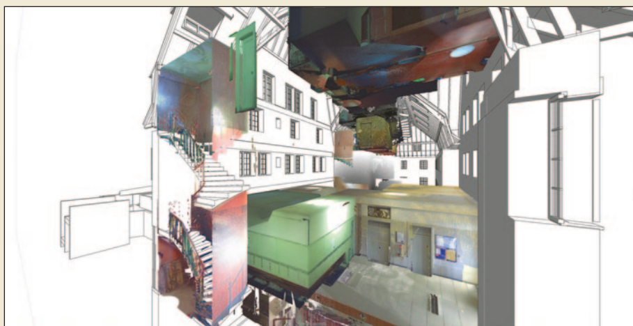
Fig. 2 - Les nuages de points, ici produits par la HEIG-VD, servent de gabarits pour la production de la maquette numérique. La modélisation de l'escalier balancé (à gauche de l'image) est aidée par l'intelligence artificielle inhérent au logiciel de CAO.
