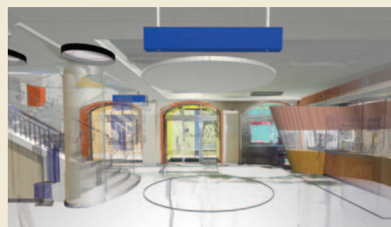
Fig. 10 - Exploration virtuelle du nuage de points du hall d'entrée de la gare de Vallorbe compilé avec la maquette numérique d'architecture dans un environnement commun de données (CDE). La simulation de transformation concerne l'accès aux personnes à mobilité réduite : en modifiant le guichet actuel un passage vers un ascenseur (en dehors de cette vue) est libéré.
