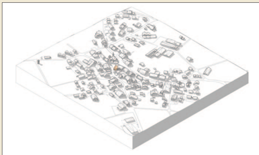
Fig. 7 - Compilation de modèles swisstopo : swissBUILDINGS3D 2.0 («level of detail» ou LOD 2, du système d'information géographique) et swissALTI3D dans un logiciel de CAO.
