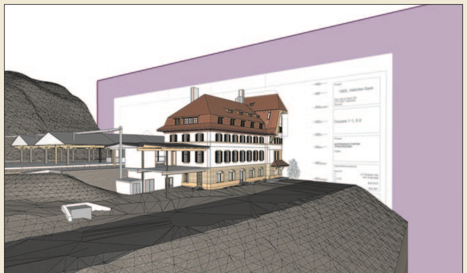
Fig. 5 - Les plans ne sont plus dessinés mais extraits par algorithmes de la maquette numérique. Ici une coupe à travers la gare de Vallorbe.
