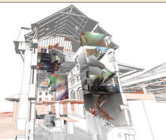
Fig. 6 - Représentation du jumeau numérique de la gare comprenant : les nuages de points des géomaticiens (surfaces en couleurs), le modèle topographique de swisstopo, la maquette de l'ingénieur en technique du bâtiment et celles de l'architecte (en noir l'existant, en rouge les objets à construire selon la SIA 400).
